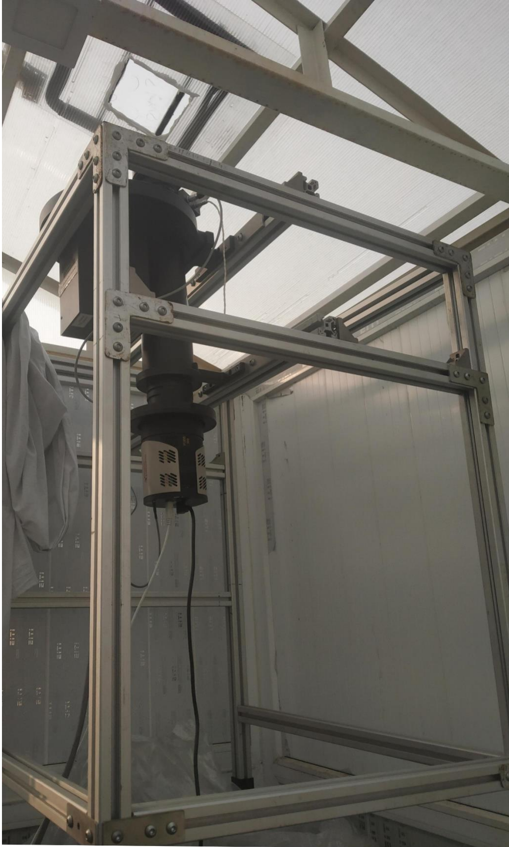
Instrument Name : All Sky Airglow CCD Imager
